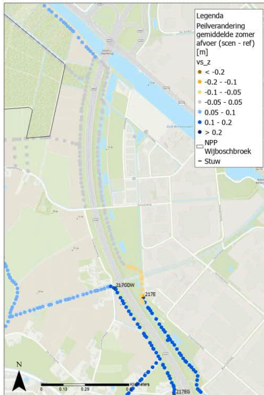
Afbeelding 5-7 Peilverandering door maatregelen bij een gemiddelde zomer afvoer (m) bovenstrooms van het Wijboschbroek
