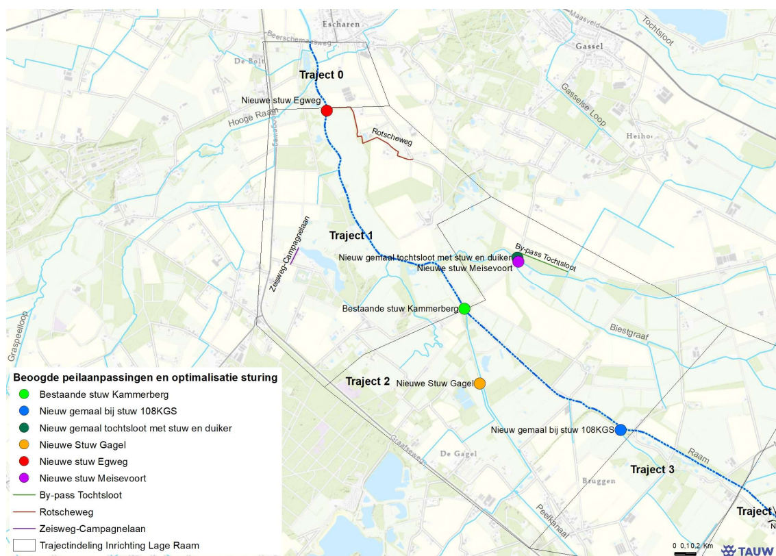
Figuur 4.2: Beoogde locaties peil aanpassingen en optimalisatie sturing watersysteem
