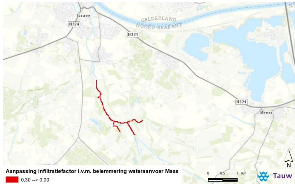
Figuur 2.6 Situering aanpassing infiltratiefactor in verband met belemmering wateraanvoer Maas (van 0,30 naar 0,00)
