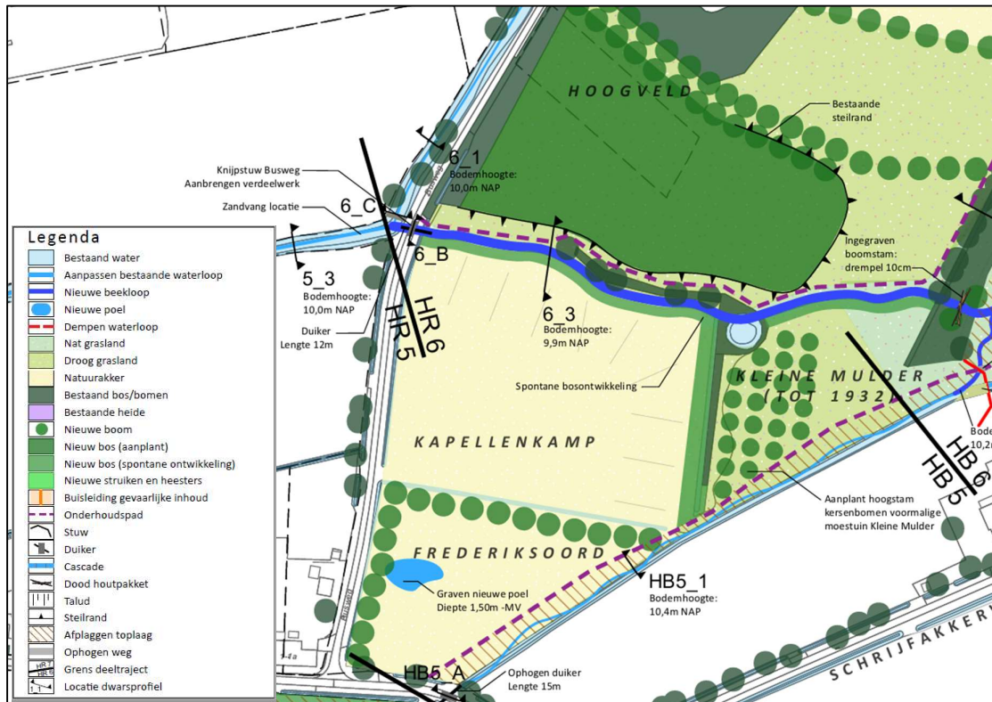
Figuur 4.8: DO Hooge Raam traject 6 – Maatregelen rondom nieuwe meander: duiker tot bestaande houtwal
