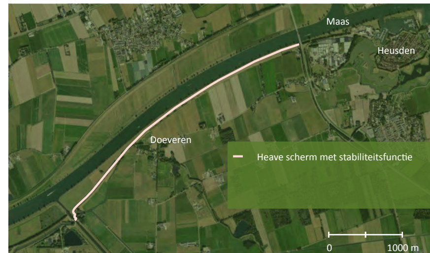
Figuur 3-2: Dijkverbetering met constructies
