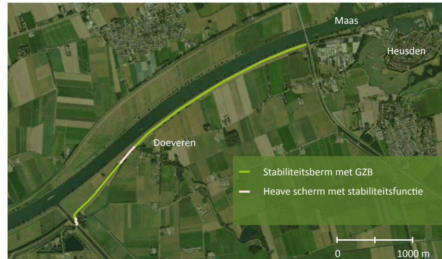
Figuur 3-3: Dijkverbetering met beperkt ruimtebeslag
