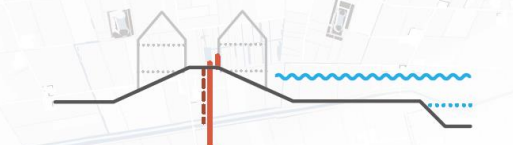
Bij waardevolle elementen aan beide zijden van de dijk: coupure met schotten, beweegbare kering of muurtje
