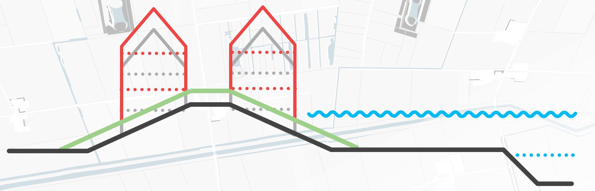
Huizen op de dijk groeien mee met de dijk
